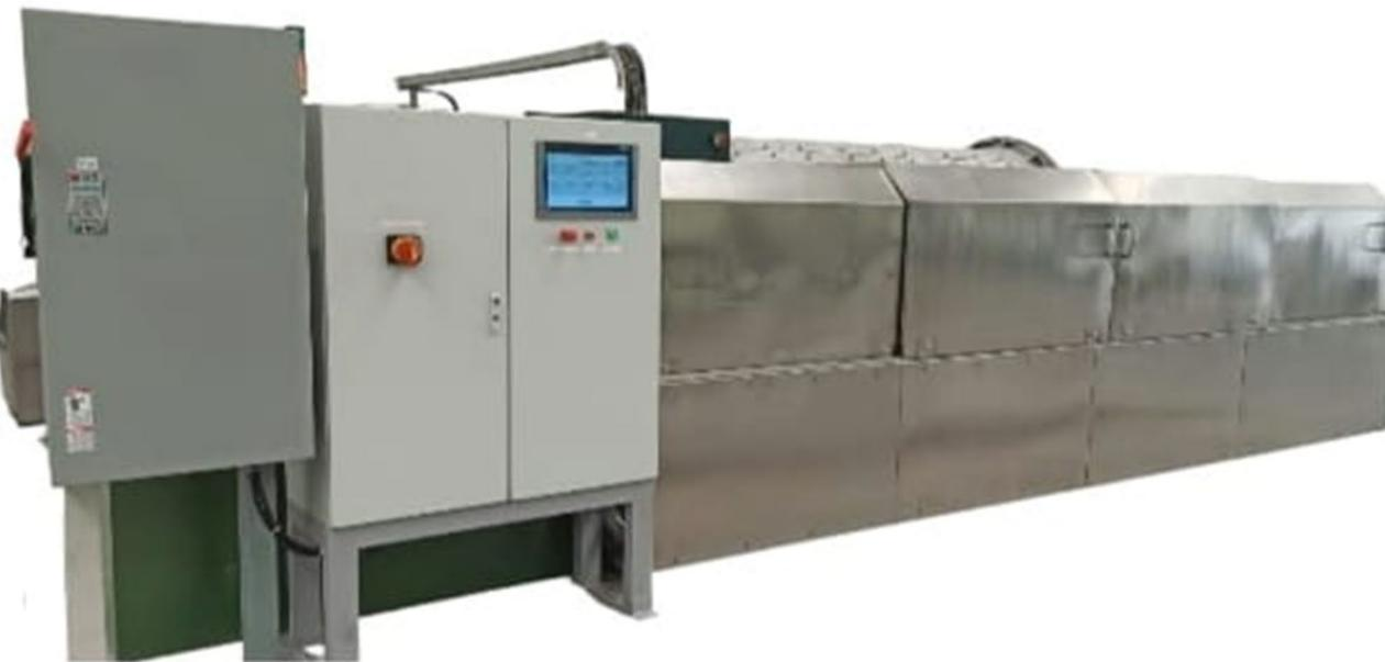
Máquina automática, fabricada en acero inoxidable T304, diseñada para un proceso continuo por hélice, con volteadores, puertas corredizas para fácil acceso al sistema de drenado, sistema de drenado manual hacia conexión al desagüe y túnel de secado de aire caliente, guardas de protección en partes móviles.
