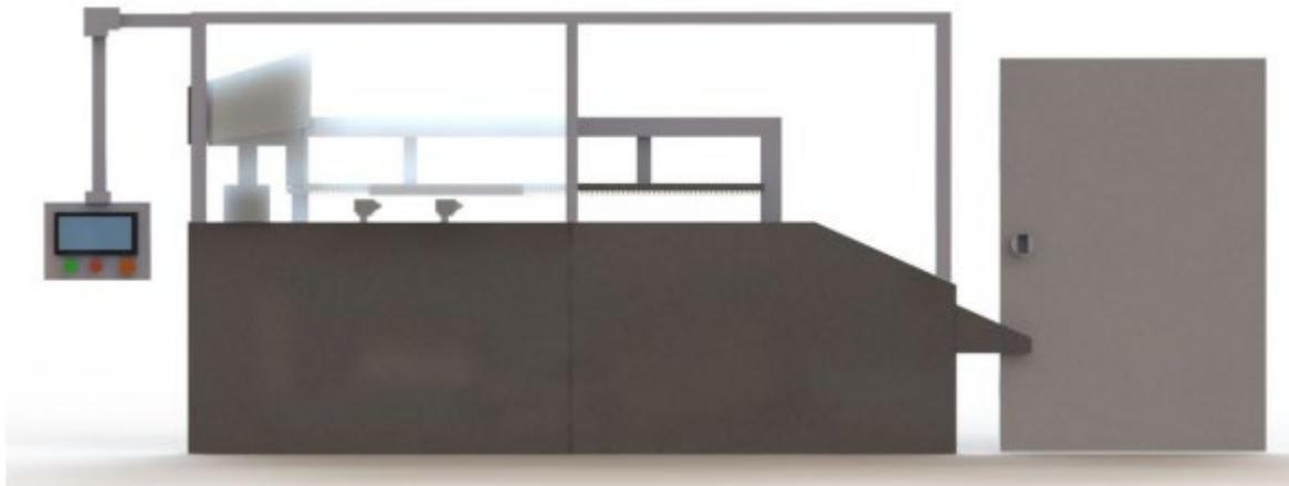
Esta máquina automática destinada al pintado de municiones logra un proceso eficiente y continuo en el pintado de ojivas, cuenta con ventanas corredizas para un fácil acceso en trabajos de mantenimiento y supervisión. Se implementan guardas de protección en partes móviles y múltiples botones de paro de emergencia.
